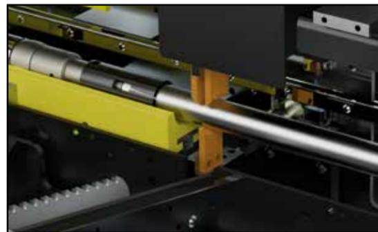
**MEHRFLÄCHEN**-Magazin mit 4 Ebenen zu je 200 mm (mit Überlagerungs-Schutz ab einem Mindestdurchmesser von 6 mm und ohne Überlagerungs-Schutz ab einem Durchmesser von 10 mm).
